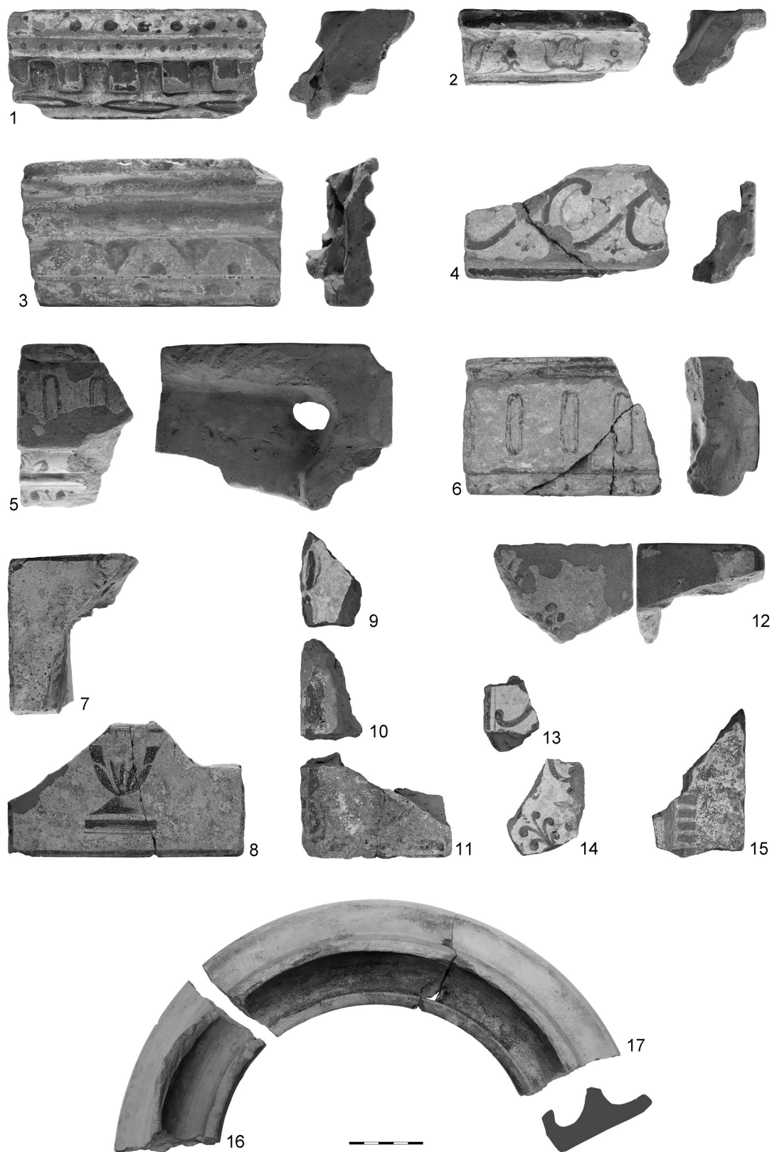
Рис. 6. Изразцы и элементы печной конструкции XVIII-XIX вв. 1-15 – изразцы, 16-17 – вьюшки.
